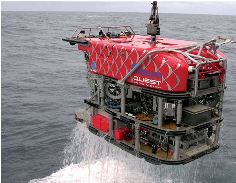
Abb. 9b: ROV QUEST des MARUM, Bremen. Einsatztiefe bis 4000 m Wassertiefe.
