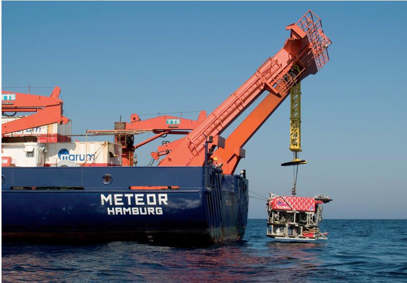
Abb. 9a: Aussetzen eines Remotely Operated Vehiclec (ROV) vom Forschungsschiff METEOR aus (MARUM, V. Diekamp).
