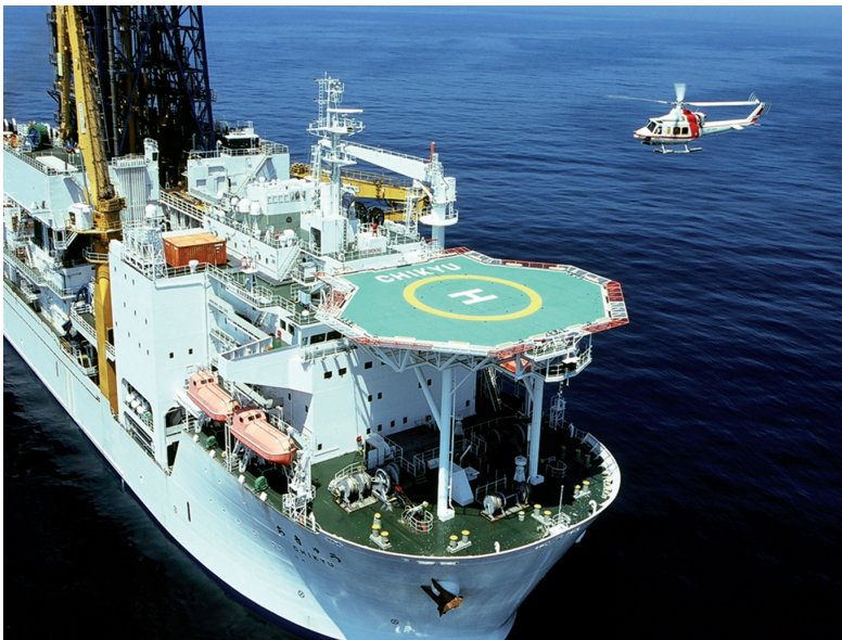
Abb. 13b: Japanisches Bohrschiff CHIKYU (Japanisch „die Erde“), ausgerüstet mit einem geschlossenen Spülkreislauf und blow-out preventer.
