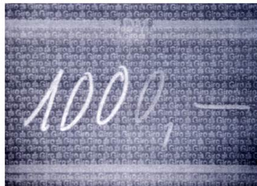
Unterschiede in der Lumineszenz zweier blau einfärbender Kugelschreiberpasten bei einem anregenden Licht von 440-580nm und einem Kamerafilter, der für Licht unterhalb von 695nm undurchlässig ist.
