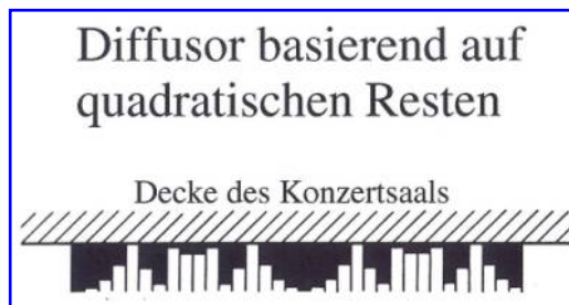
Abbildung 4: Quadratic-Residue Diffusor (QRD), auf der Primzahl 17 als Periode beruhend. Derartige Strukturen sind weltweit als „Schroeder-Diffusoren“ bekannt und auch in der Göttinger Stadthalle zu finden (D. Püschel, Akustik Technologie, Göttingen). Die Wahl von 17 als Periode erlaubt die effiziente Schallstreuung von vier musikalischen Oktaven.
