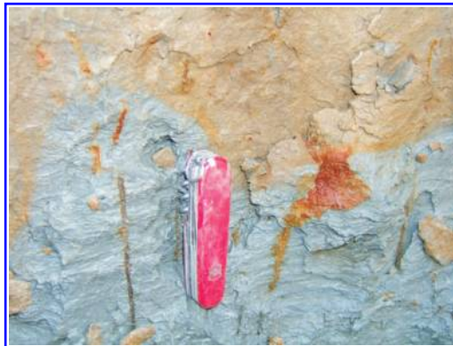
Abbildung 5: Sedimentmaterial eines arsenkontaminierten Grundwasserleiters in Bangladesch. Die rot-braunen Bereiche kennzeichnen oxische eisenoxidhaltige Schichten, in denen das Arsen an die Oxide gebunden vorliegt. Die grauen Bereiche sind reduzierte, also sauerstofffreie Bereiche, in denen eisenreduzierende Mikroorganismen Eisenoxide aufgelöst und so das Arsen freigesetzt haben.
